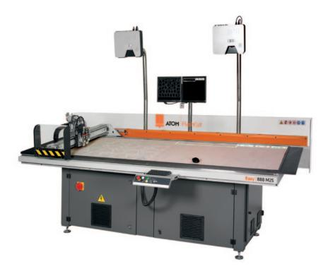
Il modello **Easy 888 M25** rappresenta la scelta ottimale per il taglio delle pelli nei comparti calzaturiero e pellettiero. La capacità di eseguire su una vasta gamma di materiali lavorazioni di taglio, marcatura e perforatura, unita all'estrema facilità e flessibilità d'uso, lo rendono la scelta ottimale per le aziende che intendono automatizzare il processo di taglio.
